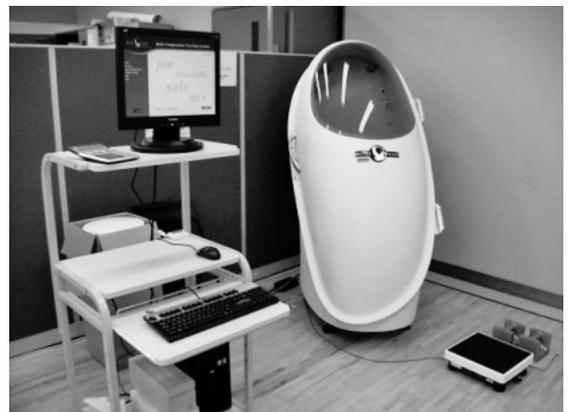
写真2 ● 空気置換法体脂肪測定装置（Bod Pod: LMI社製、写真提供：国立スポーツ科学センター）
